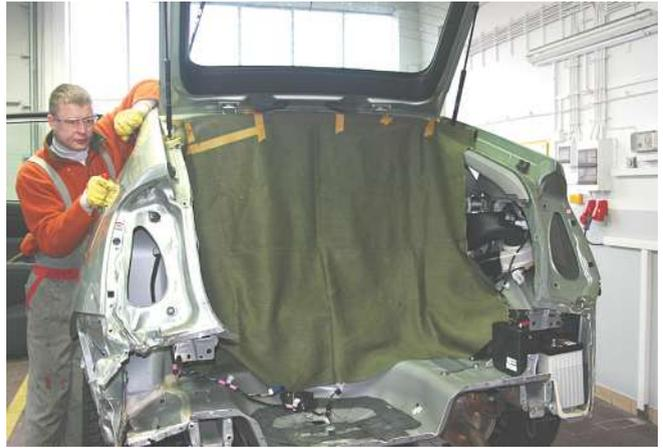
**Bilder 7.2b und 7.1c** Funkenfeste Abdeckplanen gehören zu jeder Karosseriereparatur.
