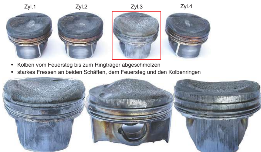
Bild 3.82 Kolben des Schadensmotors, Hauptschaden Kolben 3 [Bild: Motorenakademie Wild]
