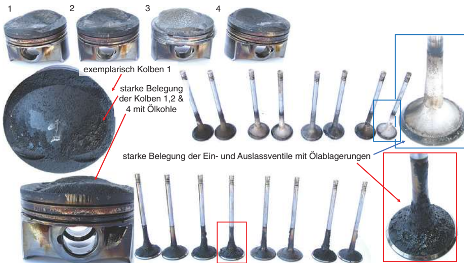
Bild 3.85 Auffällig starke Ölkohlebelgung an Kolben und Ventilen der Nachbarzylinder zum Hauptschaden [Bild: Motorenakademie Wild]
