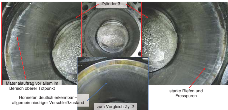
Bild 3.83 Adhäsiver Verschleiß und Fresser an Zylinder 3, Zylinder 2 zum Vergleich [Bild: Motorenakademie Wild]
